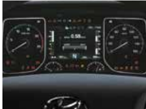
Computador a bordo con pantalla LCD TFT a color de 7”
